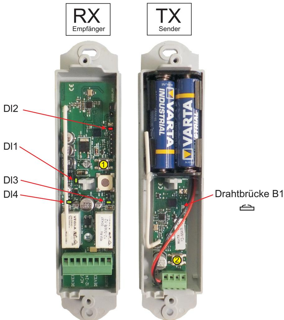
Funktion: im Ruhezustand bei angeschlossenen Kontaktleisten leuchtet die DI1 und DI4 auf, sobald der Sicherheitskreis geöffnet wird erlischt die DI4 und die DI2 leuchtet rot - der Relaiskontakt ist nun geöffnet.
