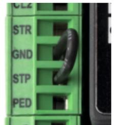
Die Brücke GND STP wird entfernt.
