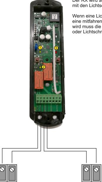
12-24V Spannungsversorgung von der Motorsteuerung
