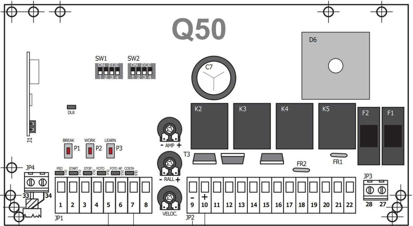
Die Drahtbrücke 5 auf 6 wird entfernt wenn eine Lichtschranke angeschlossen ist.
