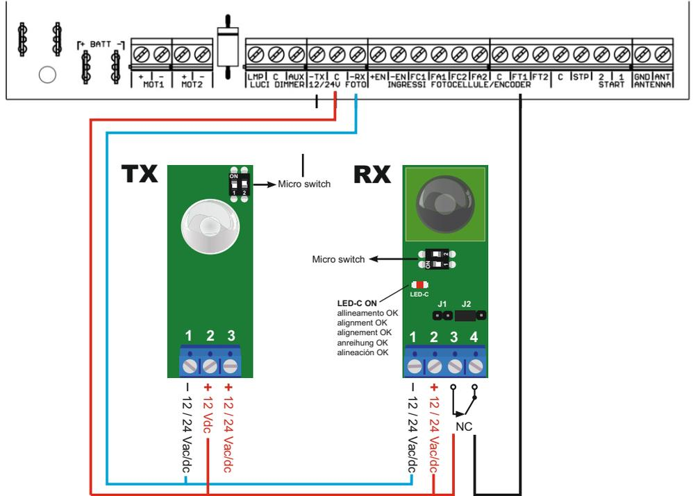
Verbinden Sie Fotozelle nach dem Schema.
