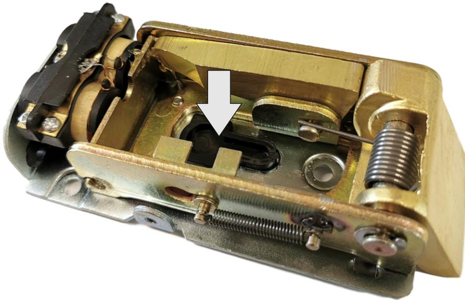
2. Schließzylinder zusammensetzen und wie hier dargestellt in die Front einsetzen-
